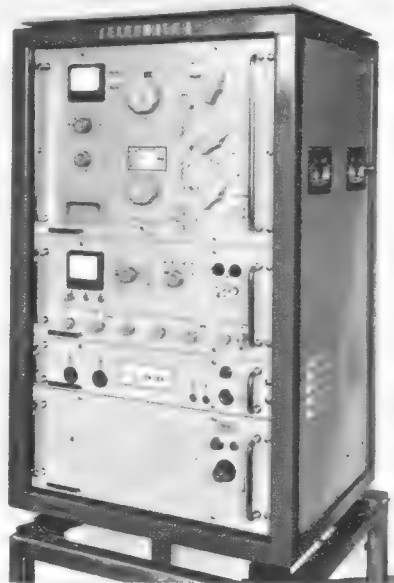
Bild 5. 400-W-Kurzwellensender mit dekadischer Steuerstufe und universell brauchbarer Antennenabstimmung (Telefunken)
