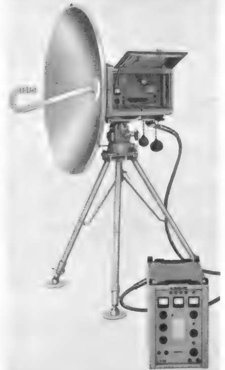
Bild 1. Tragbare Fernseh-Reportage-Richtfunkanlage FM TV/7000 R von Felten & Guillaume. Vorn der abgesetzte aufzustellende Senderbedienungskasten
