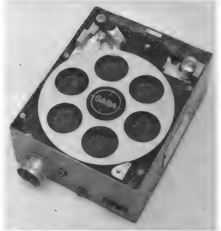
Bild 11. Robustes Magnetband-Aufzeichnungsgerät für Weltraumsatelliten (Saba/PI)
