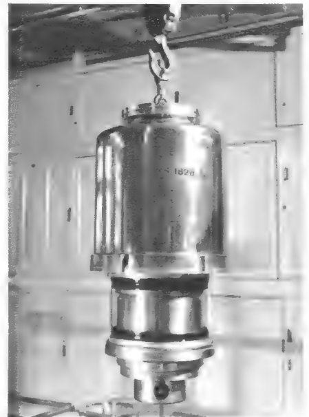
Bild 6. 500-kW-Senderöhre RS 1828 mit Siedekühlung
